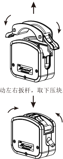
C 放入压块总成，扳动左右扳杆将压块总成锁死。
